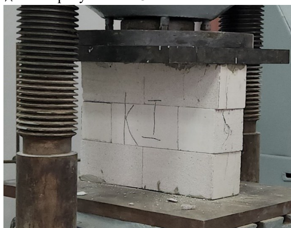
Рис. 3. Образец ПУ после разрушения
