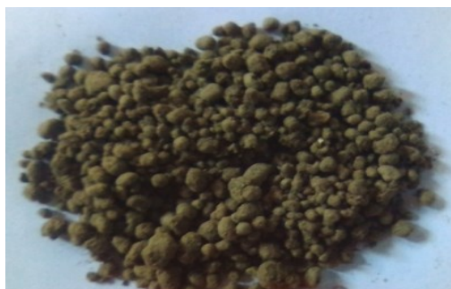
Рис. 4. Сферические микрофибронеполнители из БВО
