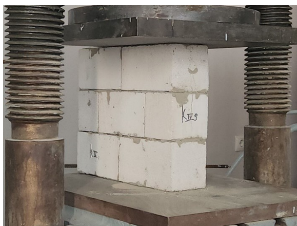
Рис. 2. Образец ЦПР после разрушения
