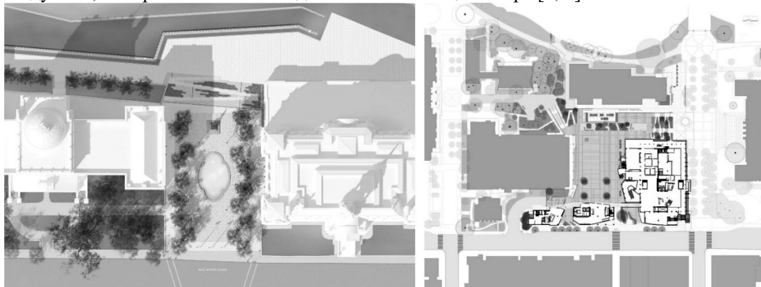
Рис. 1. Объёмно-планировочные решения организации крутого рельефа с применением лестниц и пандусов: слева – схема генерального плана Воклен Сквер, Монреаль, Канада [Источник: makingmtl.ca/placevaquelin/widgets/6101/photos/2309 ]; справа – схема генерального плана Калифорнийского университета, Беркли, Калифорния, США [Источник: archdaily.com/870467/lower-sproul-redevelopment-moore-ruble-yudell-architects-and-planners ]
